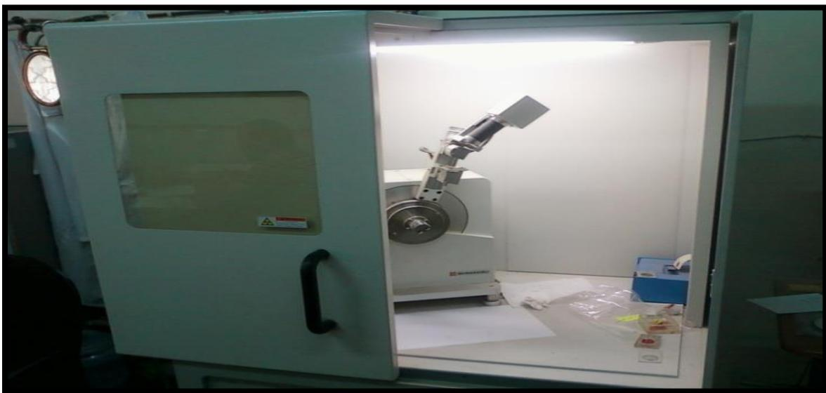
الشكل (9-3): جهاز حيود الأشعة السينية (XRD).
