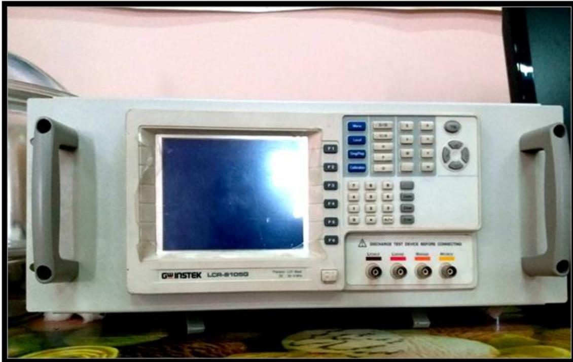
الشكل (14-3): جهاز فحص الخصائص الكهربائية (LCR Metter).
